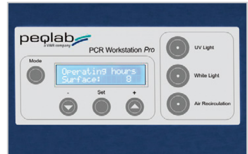
Übersichtliches Bedienfeld mit Display. Optionale Anzeige der UV-Röhren-Laufzeit ermöglicht rechtzeitigen Röhrenwechsel für gleichbleibende UV-Intensität.
