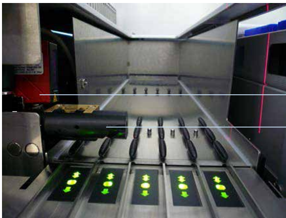
Positionen von Barcode-Reader und Abstandshalter.
