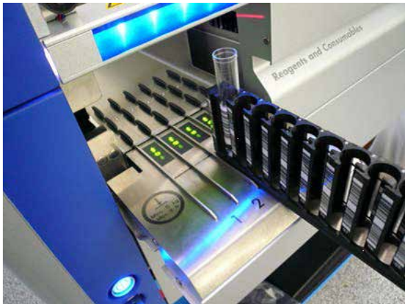
Einschieben eines Proben-Gestells in den geeigneten Stellplatz.
